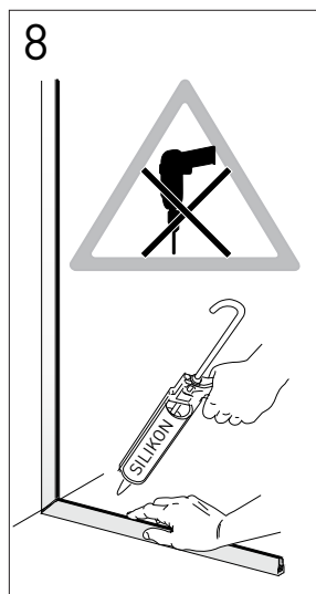
Golvprofilen skall limmas i underlaget. Täta skarven mellan golv och väggprofil med silikon. Fixera golvprofilen med tejp under härdningstiden.
